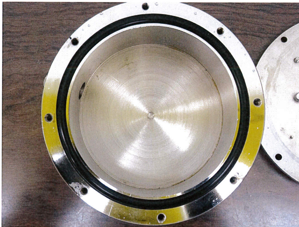
写真 7 IPX5 試験後の内部確認の様子 -2
