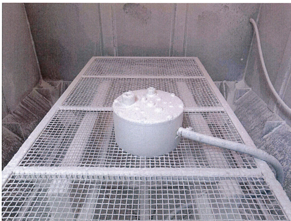
写真 2 IP6X 試験の様子
